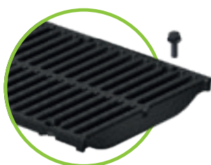
bordás öntöttvas rács RSZ 18/215, E terh. osztály, E terh. osztály 4 csavarral rögzíthető
