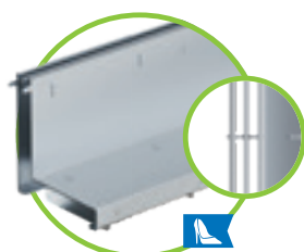
résfolyóka rátét 2S, túsarokbiztos RSZ 2x6 mm, C terh. osztály, horganyzott és rozsdamentes, NM 100 és 150
