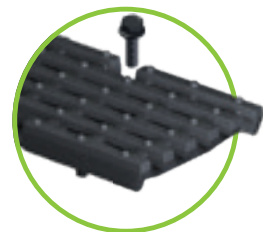
hosszbordás öntöttvas rács RSZ 22/13 E terh. osztály – 4 csavarral rögzíthető, csak öv. peremes folyókához NM 100-tól NM 200-ig
