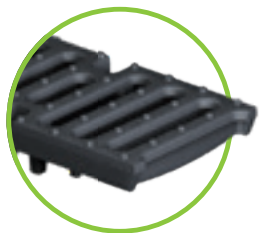
bordás öntöttvas rács RSZ 14/100, 14/150, 14/200 NM100-tól NM 200-ig E terh. osztály gyorscsatlakozó rendszerrel NM 150-hez és NM 200-hoz D terh. osztály, 4 csavarral rögzíthető
