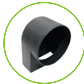
Búzzár bekötő aknához DN 100/150-es méretben utólagos beszereléshez. Beépítés: A búzzárt a bekötőakna belsejébe kell helyezni, majd a PVC csővel összekötni.
